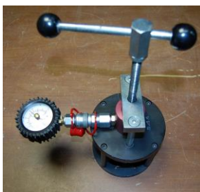
Annex 1, Hydrajaws Pullout Meter 0095
